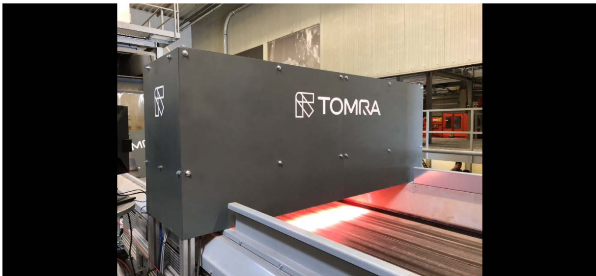
↑ NIR-Kamera der Firma TOMRA mit NIR-Beleuchtungseinheit
